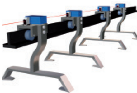
在單軌運輸裝置上的距離量測 控制產品的流量和預防零件的損壞，監控運輸裝置上的間隔。
