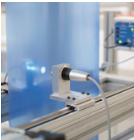
透明膜或壓克力玻璃的在線顏色確認
