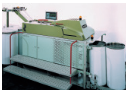
結合在OEM紡織品的機台 渦電流感測器量測在紡織品機台上的紡線厚度變化。
