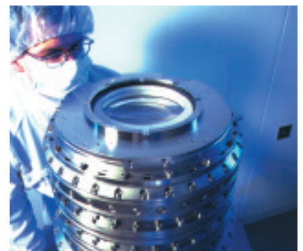
應用： 在晶元蝕刻製程，非接觸式電容位移感測器以高精密的量測提供鏡片對位。
