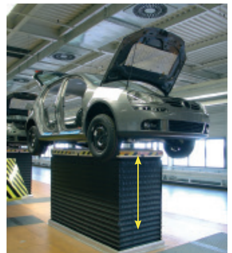
拉線式感測器監控自動汽車產品線上的平台舉起高度。
