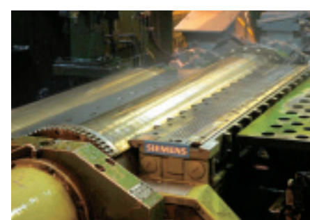
線上的品質控管 渦電流感測器量測軋鋼機上的平面度。
