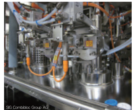
食品工業的閾高低測量 不銹鋼外殼包覆的MDS-45-Mxx系列適用於食品工業。
