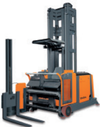
拉線式位移感測器量測叉車舉起高度，在此小型結構，使用者可讀得舉起高度值，最大至30 m。
