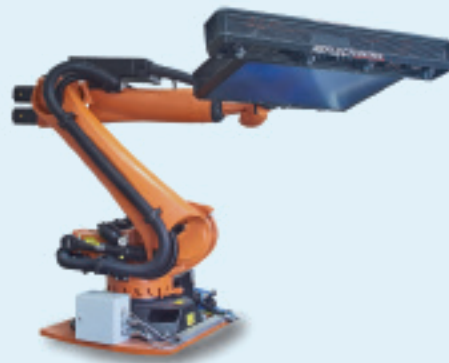
reflectCONTROL Automotive 車體烤漆全自動表面檢測 確認缺陷、凸點、刮傷
