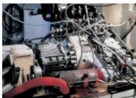
測試設備的應用 在汽車工業，這些系統量測引擎的內部尺寸改變。
