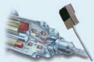
SGS主軸伸長量量測系統 應用於高速切削用主軸，量測旋轉時的伸長量 測量範圍：400 μm 解析度：0.5 μm 高溫度範圍應用
