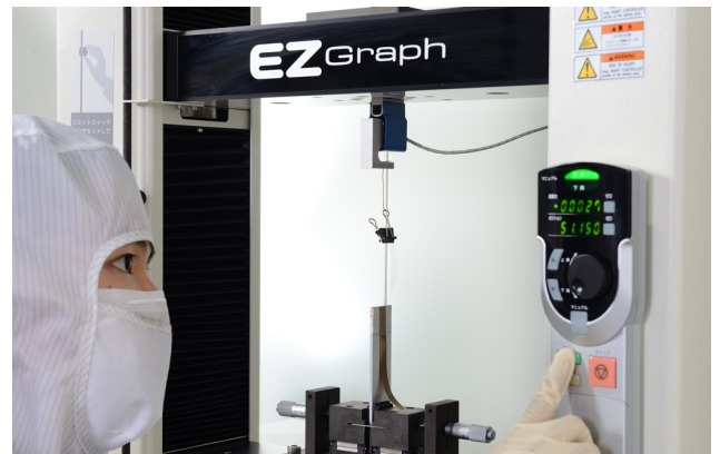
拉力量測作業
